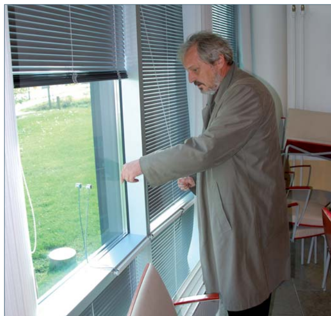
Professori Markku Heinisuo tarkastelee yhtä Alavuden Teknologiakeskus Fasardin metalli-lasi -julkisivuun asennetuista antureista, joilla on koottu tietoja ulkoseinän lämpöarvojen vaihtelusta.
