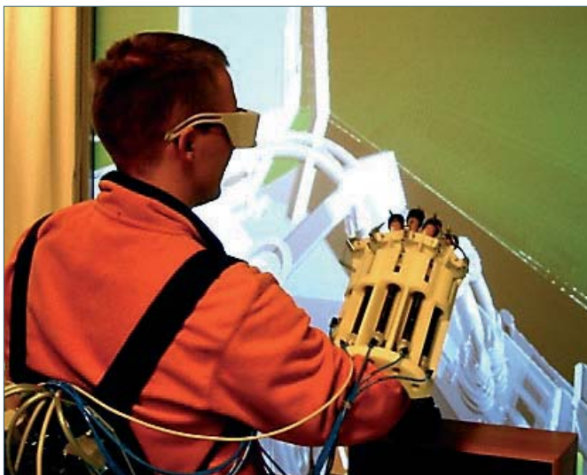
Virtuaalipintoja tunnustellaan haptiikkalaitteen avulla.
